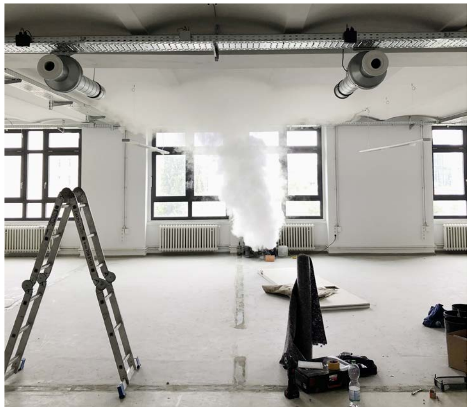
1 Versuchsaufbau zur Nachtauskühlung mit Rohrventilatoren zur Optimierung der Durchströmung.
