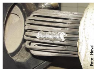
Herausgezogener Erhitzerkopf mit Temperaturmessfühler
