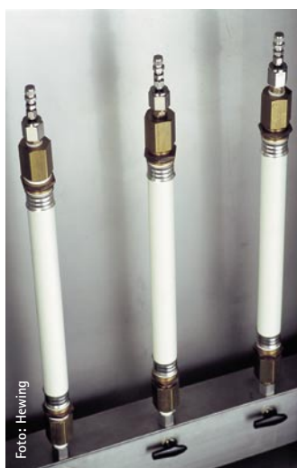
Berstdruck-Prüfung: MT-Verbundrohre unter extremen Druckbelastungen
