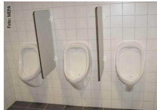
Fertig montierte Urinalanlage. Die gesamte Elektronik ist hinter dem Urinal vor ungefügtem Zugriff geschützt. Programmierung und Reinigungsfunktionen erfolgen kontaktlos mit Magnettechnik
