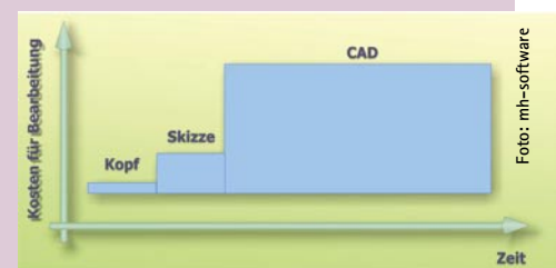
Bild 1 Zu früher Einsatz von CAD führt durch aufwendige Änderungen zu hohen Planungskosten
