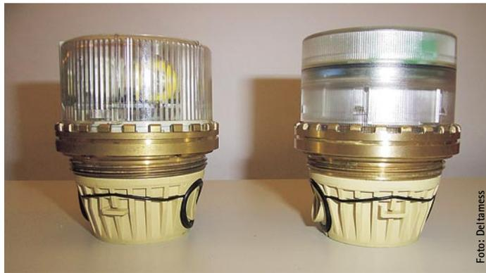
und Wiederverwendbarkeit von Komponenten zu beachten. Eine zylindrische Form des Funkmoduls ist hier besonders vorteilhaft. Das Modul lässt sich beim Aufsetzen sicher positionieren und die Plombierung ist mit dem wiederverwertbaren Material des Basiszählers möglich.
