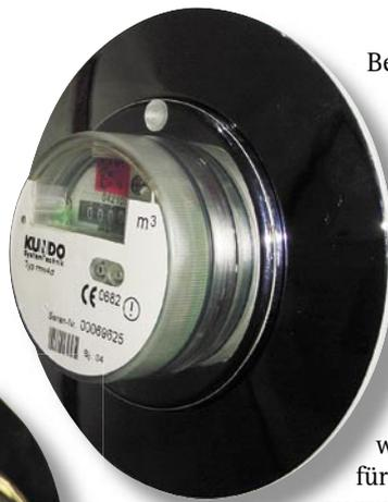
Bei Unterputzzählern ist deswegen oft eine Neugestaltung der Abdeckgarnitur erforderlich, denn Tubus und Rosette dürfen die Sendeantenne nicht abdecken. Bei tieferer Einbaulage, wenn die Antenne nicht weit genug herausragt, muss auf metallische Oberflächen, z.B. Chrom, ganz verzichtet werden. Deltamess bietet dafür Rosetten in Sanitärfarben, vorzugsweise in Sanitärweiß, an.
