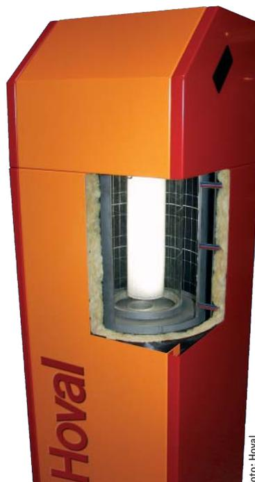
Auf der ISH 2005 stellte Hoval als Entwicklungsprojekt einen Gas-Heizkessel mit einer Wärmeleistung von 16 kW vor, der gleichzeitig thermophotovoltaisch eine elektrische Leistung von 250 W abgibt
