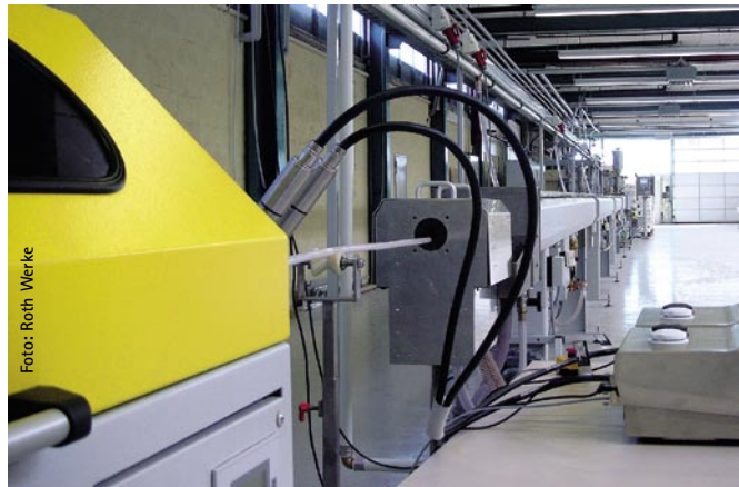
Roth: Fünf Extruder arbeiten synchron auf der neuen, rund 60m langen Produktionsstrecke
