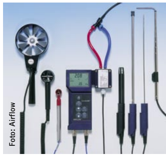
Airflow: Einregulierungssystem CombiAir CA20 für Lüftungsanlagen
