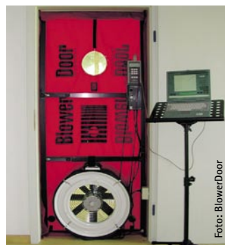
BlowerDoor: Automatische Blower-Door-Messung
