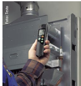
Testo: CO-Monitor testo 317-3
