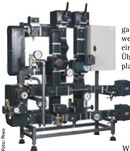
Indirekte Fernwärmeübergabestation mit Wärmeübertrager für Heizung und Wärmeübertrager für Warmwasser im Durchflussprinzip
