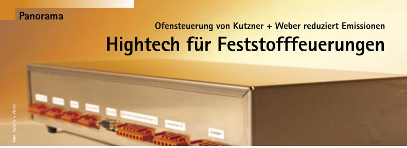
Das ist nicht die Rückseite eines Audiosystems von Bang & Olufsen, sondern der Prototyp einer elektronischen Ofensteuerung von Kutzner + Weber
