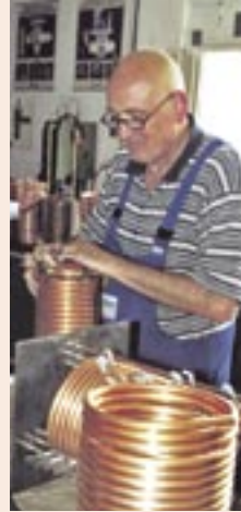
Werkstatt von Kaeltro: Manufaktur der Wärmeübertrager für den Sondenkopf. Rechts ist die Wärmepumpen-Versuchsordnung mit Messdatenprotokollierung abgebildet
