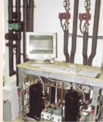
Werkstatt von Kaeltro: Manufaktur der Wärmeübertrager für den Sondenkopf. Rechts ist die Wärmepumpen-Versuchsordnung mit Messdatenprotokollierung abgebildet
