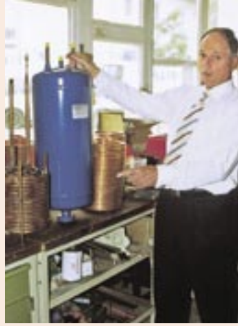
Werkstatt von Kaeltro: Manufaktur der Wärmeübertrager für den Sondenkopf. Rechts ist die Wärmepumpen-Versuchsordnung mit Messdatenprotokollierung abgebildet
