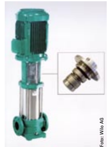
Wilo-Multivert MVI: Ab 11 kW Wechsel der Gleitringdichtung ohne Motorausbau
