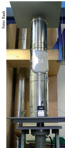
Foto: Raab Raab: Versuchsaufbau zur Bruchlastermittlung
