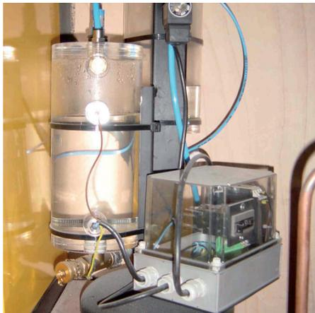
Bild 3 Instrument zur Messung der entfernten Gasmenge
