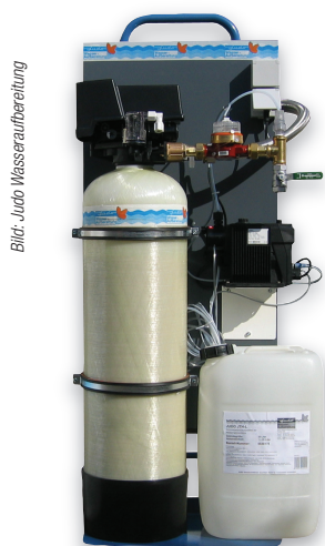
Bild 3 Mobile Heizungsschutzanlage mit Rohwasserfilter, Rohrtrenner, Enthärtungsanlage, wasserzählergesteuerter Dosieranlage, Füllgruppe und Regenerierstation auf einer Transportkarre. [JMHB]
