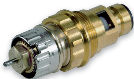
Bild 1 Nachrüstbarer voreinstellbarer Ventileinsatz von Danfoss. Für eine störungsfreie hohe Regelgenauigkeit ist bei den kleinen erforderlichen Querschnitten eine einwandfreie Wasserqualität erforderlich.
