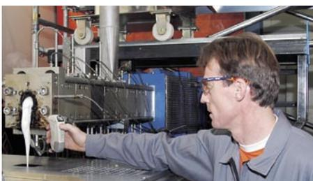
Messung der Extrudat-Temperatur am Einlauf eines Walzenkühlers im BBA Innova-Technikum.
