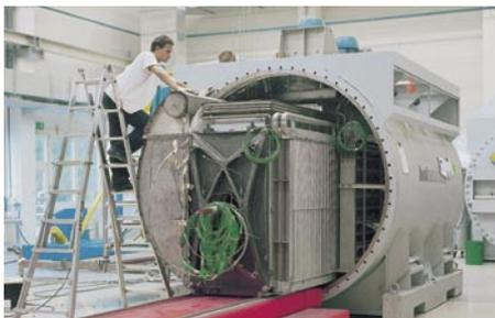
*Produktion eines HotModules. In der Schmelzkarbonat-Brennstoffzelle können methanreiche Erd-, Bio-, Klär-, Gruben- und Deponiegase sowie Methanol eingesetzt werden. Die Reformierung und der elektrochemische Prozess laufen bei circa 650 °C ab.*
