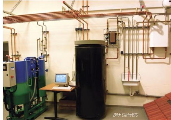
Citrin: Versuchsaufbau solares Kühlen mit Absorptionskältemaschine
