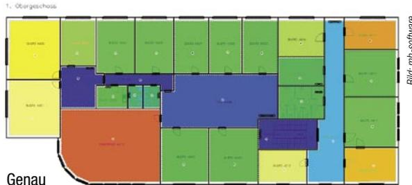
Ergebniskontrolle: Farbanalyse in Abhängigkeit wählbarer Parameter (hier: spez. Heizlast)
