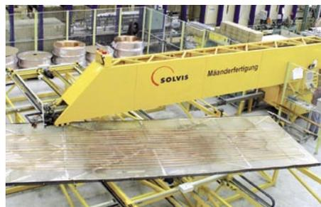
*Herstellung von Rohrregistern im Braunschweiger Solvis-Werk*
