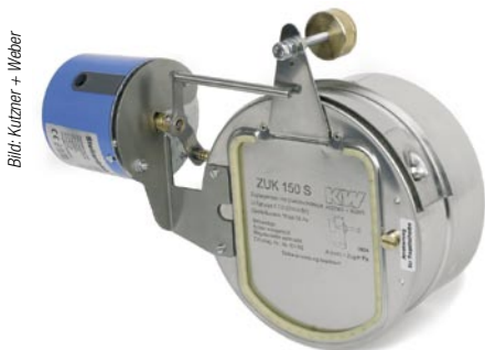
Zugbegrenzer Z 150 S mit Motorsteuerung. Montage rechts: In Betriebspausen wird die Regelscheibe geöffnet. Montage links: Die Regelscheibe wird in Betriebspausen geschlossen.
