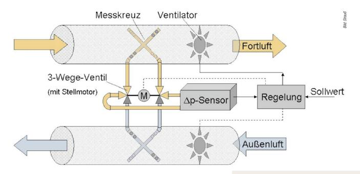
AirSwitcher-Konzept einer kostengünstigen Massenstromregelung für Wohnungslüftungsanlagen.
