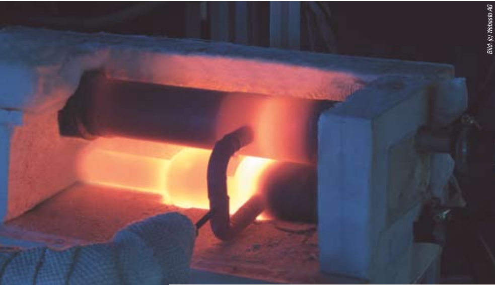
Glühender Reformer einer Auxiliary Power Unit (APU) im Entwicklungslabor von Webasto.
