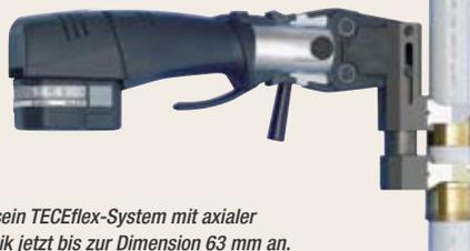
Tece bietet sein TECEflex-System mit axialer Pressetechnik jetzt bis zur Dimension 63 mm an.
