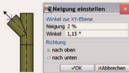
Plancal: Darstellung einer Gefälleingabe am Abzweig.
