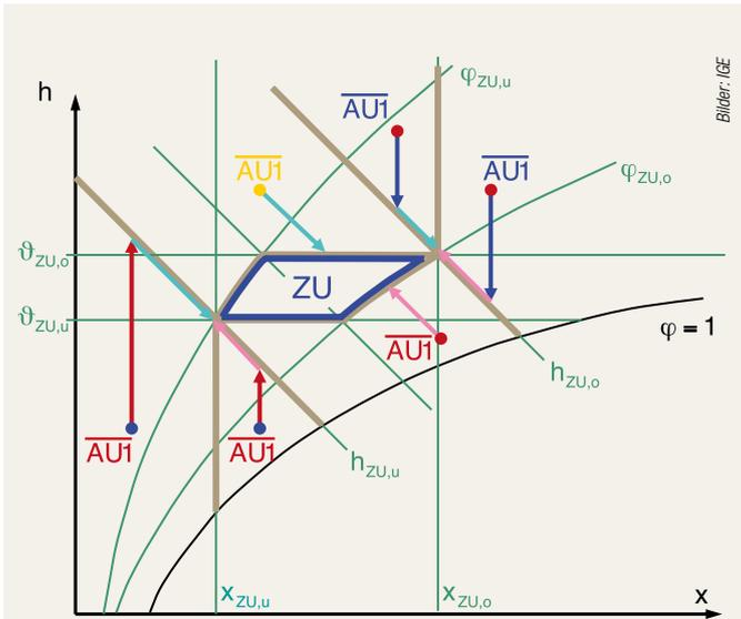
Bild 1 Darstellung der idealen Prozesse im  $h,x$ -Diagramm.
