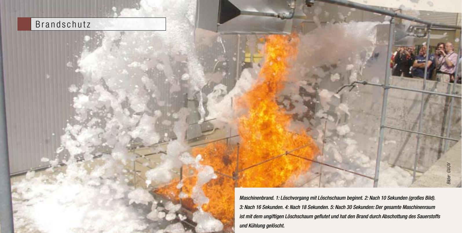
Maschinenbrand. 1: Löschvorgang mit Löschschaum beginnt. 2: Nach 10 Sekunden (großes Bild). 3: Nach 16 Sekunden. 4: Nach 18 Sekunden. 5: Nach 30 Sekunden: Der gesamte Maschinenraum ist mit dem ungiftigen Löschschaum geflutet und hat den Brand durch Abschottung des Sauerstoffs und Kühlung gelöscht.
