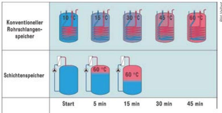
Schneller und auch mehr warmes Wasser und eine bessere Brennwertausnutzung kennzeichnen Schichtenspeicher mit externen Wärmeübertragern.
