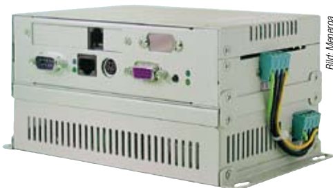
Der Freezmo Web-Datenlogger zeichnet Betriebsdaten von Menerga-Zentralklimageräten auf und sendet bei Bedarf Störmeldungen per SMS und E-Mail.
