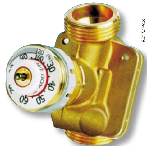
Bild 8 Das AB-QM von Danfoss kombiniert ein Regelventil und einen Volumenstromregler in einem Gehäuse. An der Skala wird der erforderliche Durchfluss eingestellt und so der dynamische Hydraulische Abgleich realisiert.
