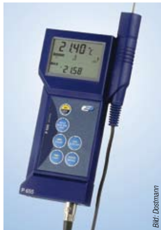
Dostmann: Das P655-LOG speichert bis zu 6000 Präzisionsmessungen in einem integrierten Datenlogger.
