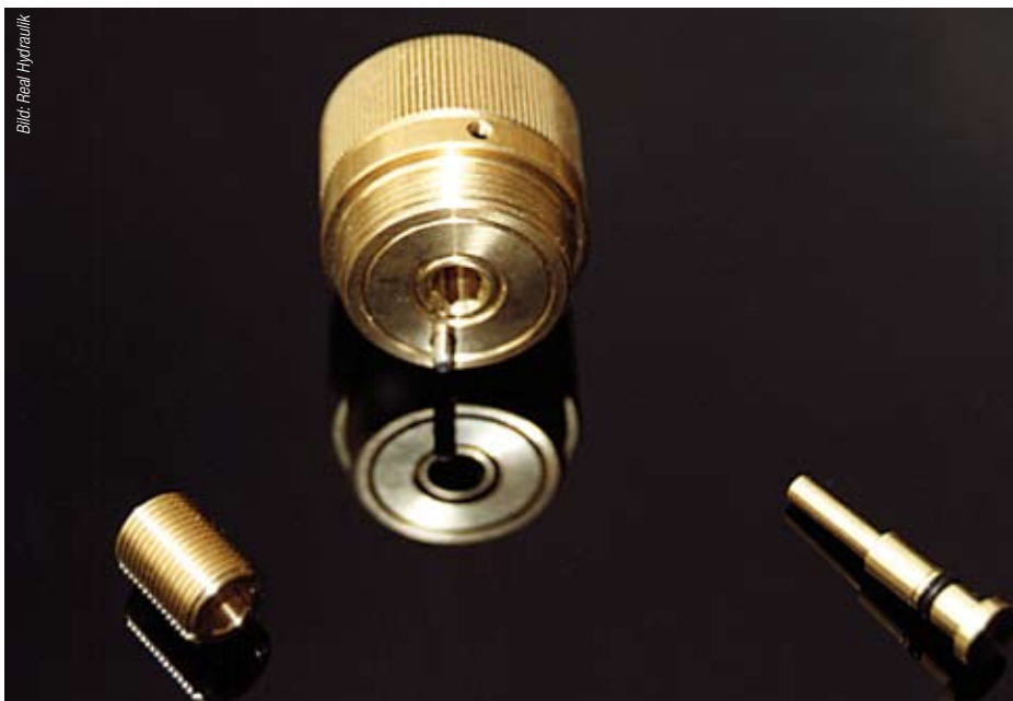
Bild 1 Volume Control Unit. a) Durch Eindrehen der Justierschraube wird das Ventil teilweise geschlossen. b) Der Thermostatkopf kann das Ventil weiterhin schließen. c) Der Ventilhub und damit auch der Volumenstrom werden durch den Teller bei großem Öffnungshub des Thermostatventils begrenzt.
