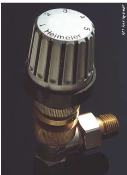
Bild 4 Nach dem Abgleich verbleibt die Volume Control Unit zwischen Thermostatventil und Thermostatkopf in der Anlage. Die fixierte Justierschraube „speichert“ den Einstellwert des Hydraulischen Abgleichs.
