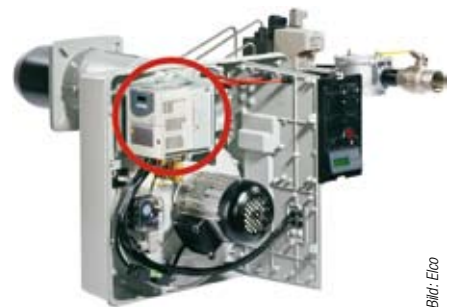
Elco: Die Aufschaltung des Feuerraumdrucks auf den Gas-/Luft-Verhältnisregler sorgt für stabile Verbrennungsergebnisse auch bei veränderten Anlagenbedingungen.
