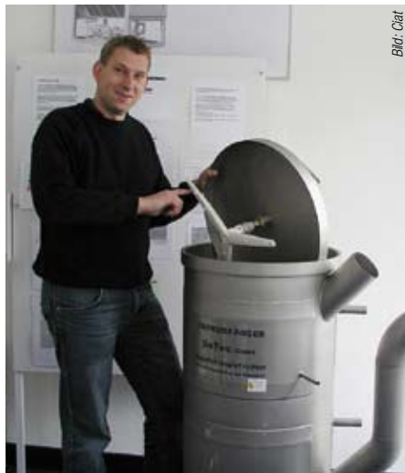
Ein Rotationsdüsenstock reinigt den Energietrichter je nach Verschmutzungsgrad des Abwassers in kontinuierlichen Zeitabständen.
