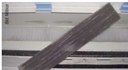
Bild 12 Filter (mit Außenluft angeströmte Fläche).
