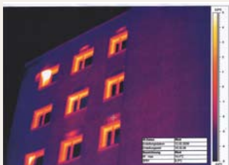
Lunos: Installation eines Lunotherm und Thermografie bei einer Fassade im Wärmedämmverbundsystem. Die maximale Temperaturdifferenz von 2 bis 3 K zwischen Hinterlüftung und Fassade ist unkritisch.
