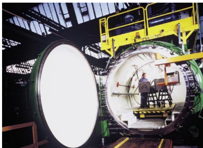
Carrier, Paul-Quentin Labor: Stahlkammer für Luftdrucktests an Wärmetauschern bis 2 MW
