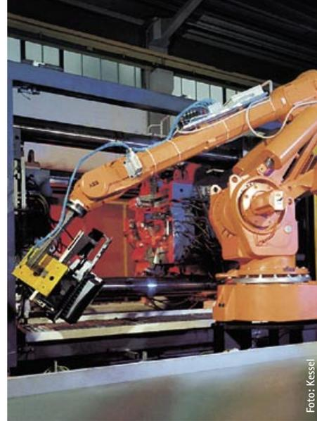
2300 t Schließkraft. Spritzgussmaschine mit 5-Armroboter
