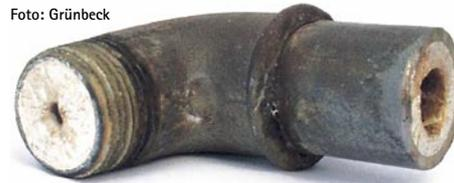
Bild 9 Verkalkter Leitungsbogen. Bei Temperaturen über 60°C besteht erhöhte Ver kalkungsgefahr
