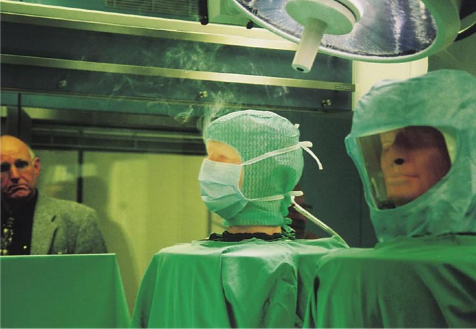
OP-Prüfraum: Sichtbarmachen eines Problems – der Atem des Chirurgen (Sonderprüfung)
