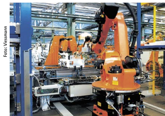
Viessmann: Fertigungsroboter für Gas-Wandgeräte
