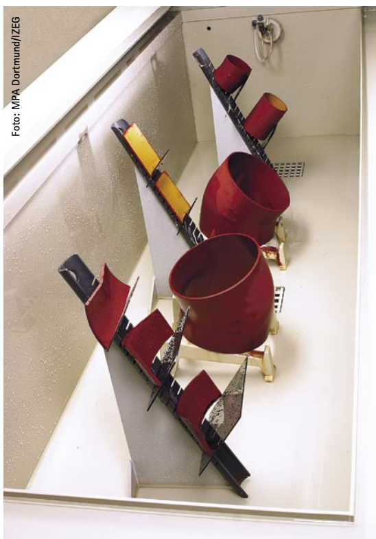
Bild 4 Geöffnete Kammer für den Salzsprüh- nebeltest mit Rohr- und Form- stückproben
