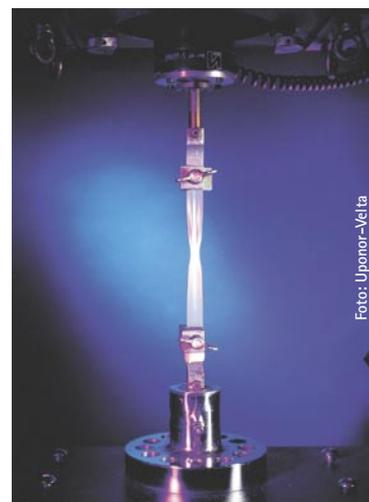
Qualitätstest eines PE-Xa-Rohrs unter Hitzeeinwirkung
