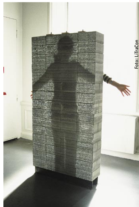
Glasfaseranteile machen Beton lichtdurchlässig
