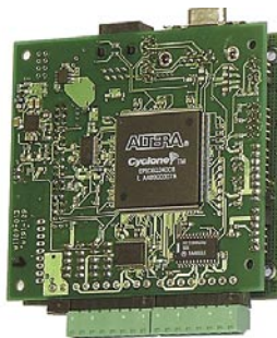
Foto: SMV Systemelektronik SMV: Sicherheitsfunkstrecke für Steuerungen
