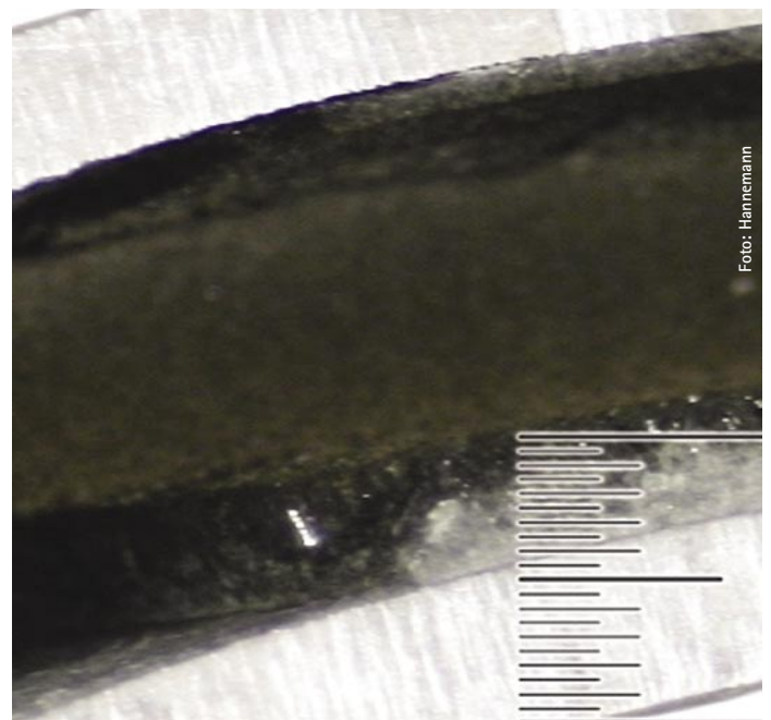
Bild 1 Teil eines geplatzten Kesselglieds mit 4,5 mm Kalk- und Oxidbelag
