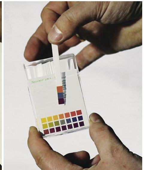
Bild 4 Der optimale pH-Wert bei Kleinanlagen liegt bei 8,5 bis 9,5. Neue Verfahren stabilisieren AISiMg-Legierungen langfristig gegen Korrosion
