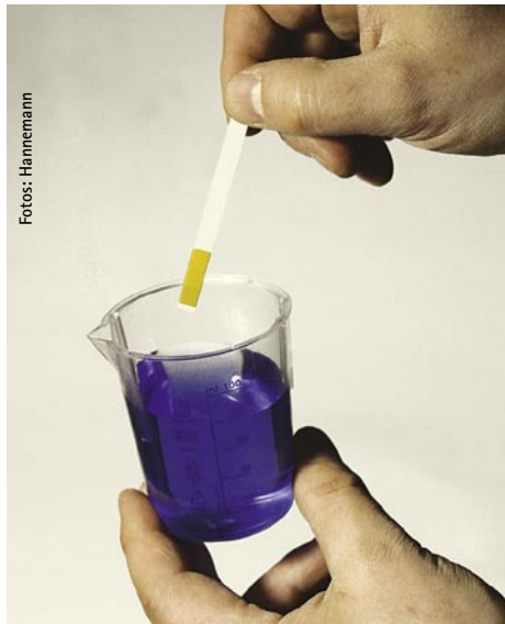
Bild 4 Der optimale pH-Wert bei Kleinanlagen liegt bei 8,5 bis 9,5. Neue Verfahren stabilisieren AISiMg-Legierungen langfristig gegen Korrosion
