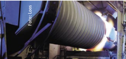
Loos: Wellrohrmaschine in Aktion
