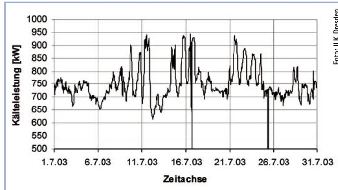
Bild 5 Beispielhafter zeitlicher Verlauf der Kälteleistung eines R718-Turbo-KWS
