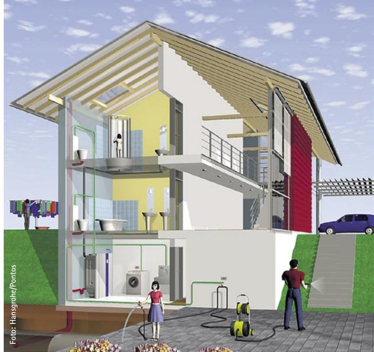
Bild 1 Zweifachnutzung: Aufbereitetes Grauwasser wird Betriebswasser für WC, Waschmaschine, Garten und Reinigung
